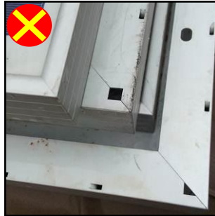
图 8.4-4 组件堆放方式错误 Wrong module stacking method
