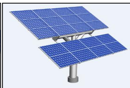
图 9.4-3 支柱安装 Pillar installation
